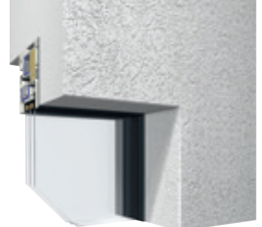
Laibungsvariante mit verdeckt liegenden Fensterrahmen
